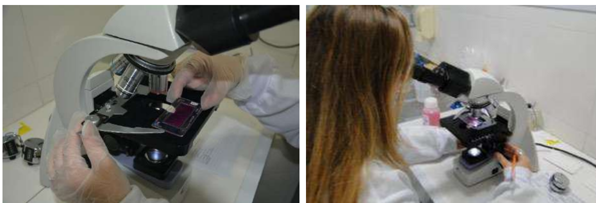
Fotos 3.2.2-3 e 3.2.2-4. Amostra na câmara de Sedgewick-Rafter preparada para análise em e identificação do zooplâncton em microscópio óptico.
