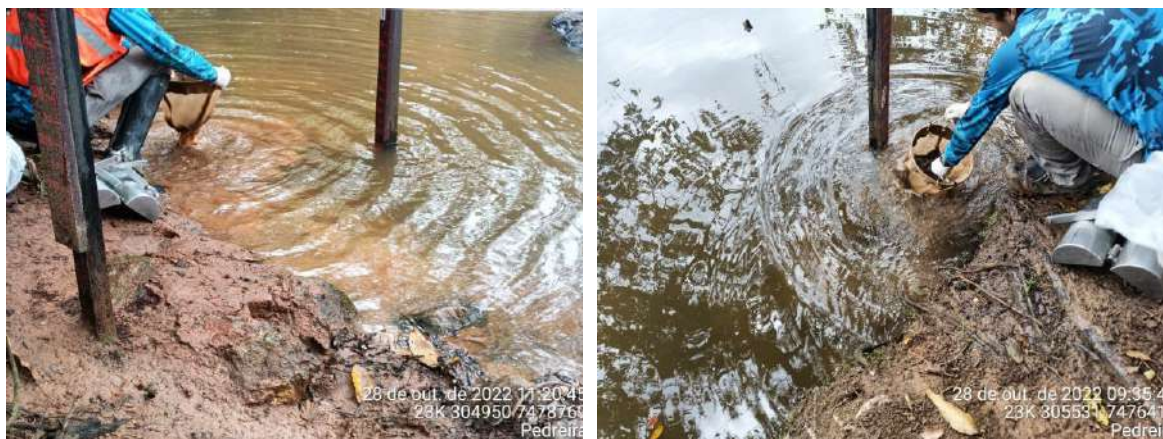
Fotos 3.2.3-1 e 3.2.3-2. Lavagem do sedimento coletado para a análise da comunidade bentônica.
